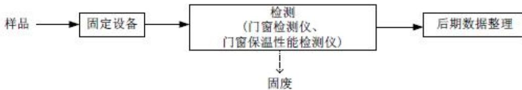
图 5-2.1 门窗试验流程图
