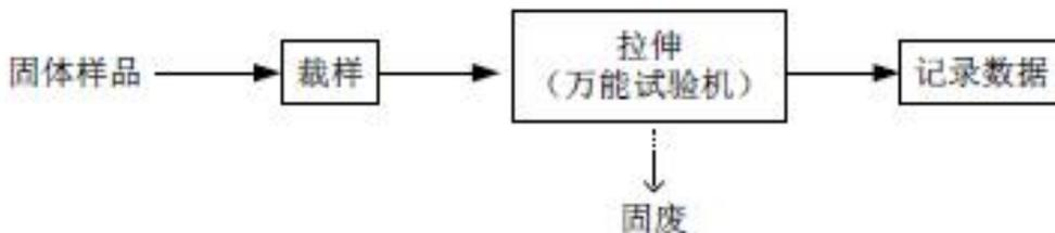
图 5-2.4 防水材料试验流程图
